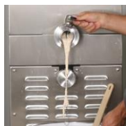
dva ventily 1. vypouštěcí ventil = v zařízení zůstane minimální množství kvasu 2. vypouštěcí ventil = úplné vyprázdnění
