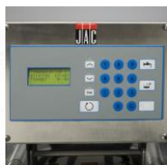
ovládací panel - program udržuje automaticky teplotu a řídí cykly zrání kvasu.
