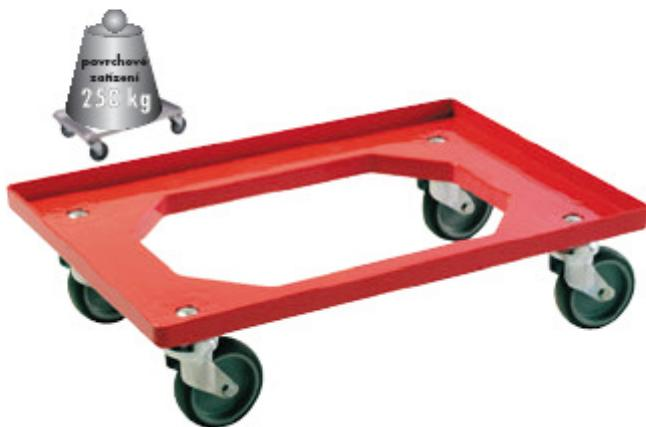
Podvozek RollBoy: Velikost 60 x 40 cm, nosnost 250 kg, rám z kvalitního plastu (ABS), schválený pro použití v potravinářském oboru, zesílené uchycení se čtyřmi řídícími kolečky, těleso kolečka pozinkované, tichoběžné gumové kolečko ( $\varnothing$  10 cm) s tělesem z termoplastu, volitelné těleso z tvrdého plastu (PA), barva: signální červená
