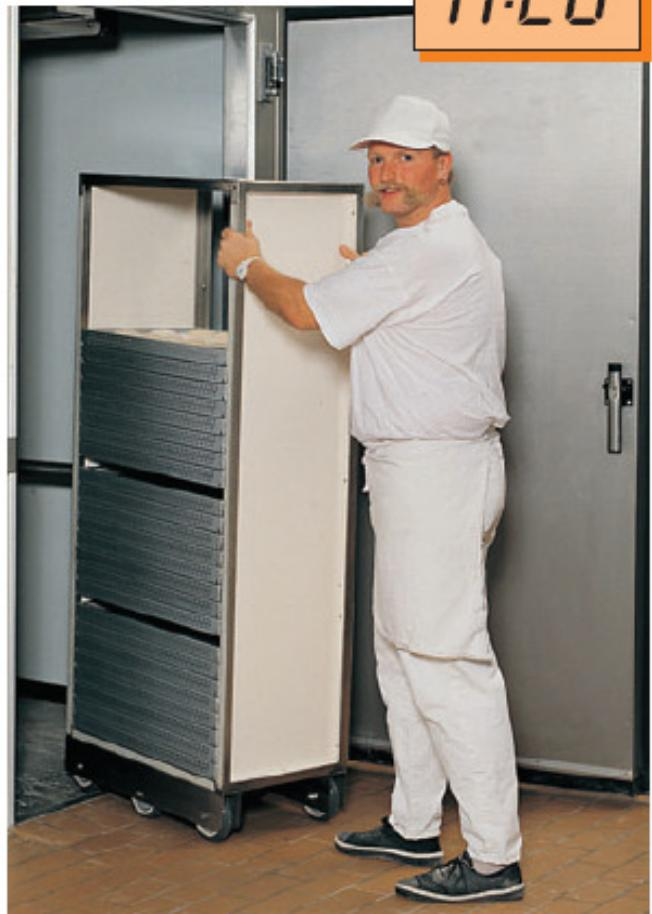
Probíhá výroba žemlí na následující den. Výroba těsta je ukončená. Z linky na žemle se na podnosy odsazují vytužené klonky. Podnosy mají po obvodě perforované boční stěny a budou uskladněné ve speciálním RollTaineru. Teď vyrobené klonky jsou určené na příští den a musí se rychle vychladit na cca 3°C, aby se zastavil proces kynutí.
