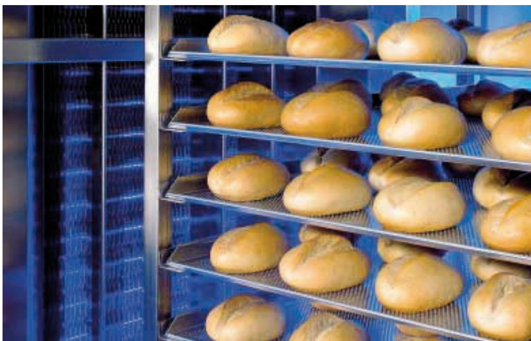
Postranně montované, výkonné odpařovací zařízení s patentovanými nastavitelnými lamelami a s integrovaným vyhříváním umožňuje rychlé a šetrné mrazení housek přímo z pece (MIWE SF-V)
