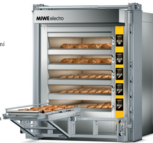
Profesionální a všestranná: elektricky vytápěná etážová pec MIWE electro s osazováním.
