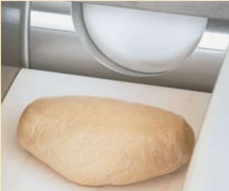
Lze vyrobit jednotlivé kusy o hmotnosti 250 – 1 600 gramů a dvojité kusy o hmotnosti 1 600 – 3 200 gramů.
