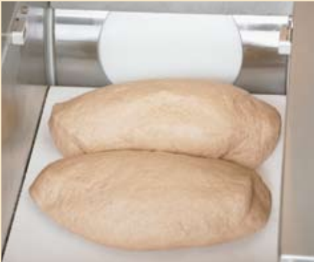
Lze vyrobit jednotlivé kusy o hmotnosti 250 – 1 600 gramů a dvojité kusy o hmotnosti 1 600 – 3 200 gramů.
