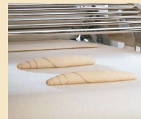
Se svinovacím zařízením (za příplatek) lze vyrábět i rohlíky, slané tyčinky, kornspitze a louhované pečivo.
