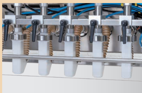
Uzavírací zařízení trysky pro viskózní náplně a zařízení pro řezání drátem pro vláknité náplně
