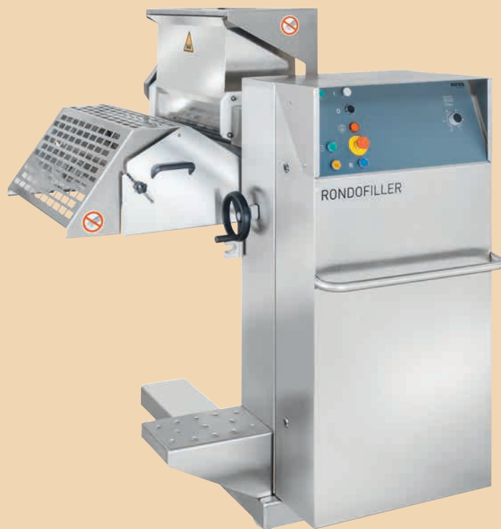
Rondofiller v kompozitním provedení Možnosti: uzavření trysky a zařízení pro řezání drátem
